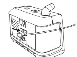
3. Collegare l'altra estremità del tubo all'interfaccia paziente. Per i circuiti con perdita, la perdita deve essere almeno di 12 l/min. a 4 cmH<sub>2</sub>O per evitare il rebreathing di aria già espirata.
